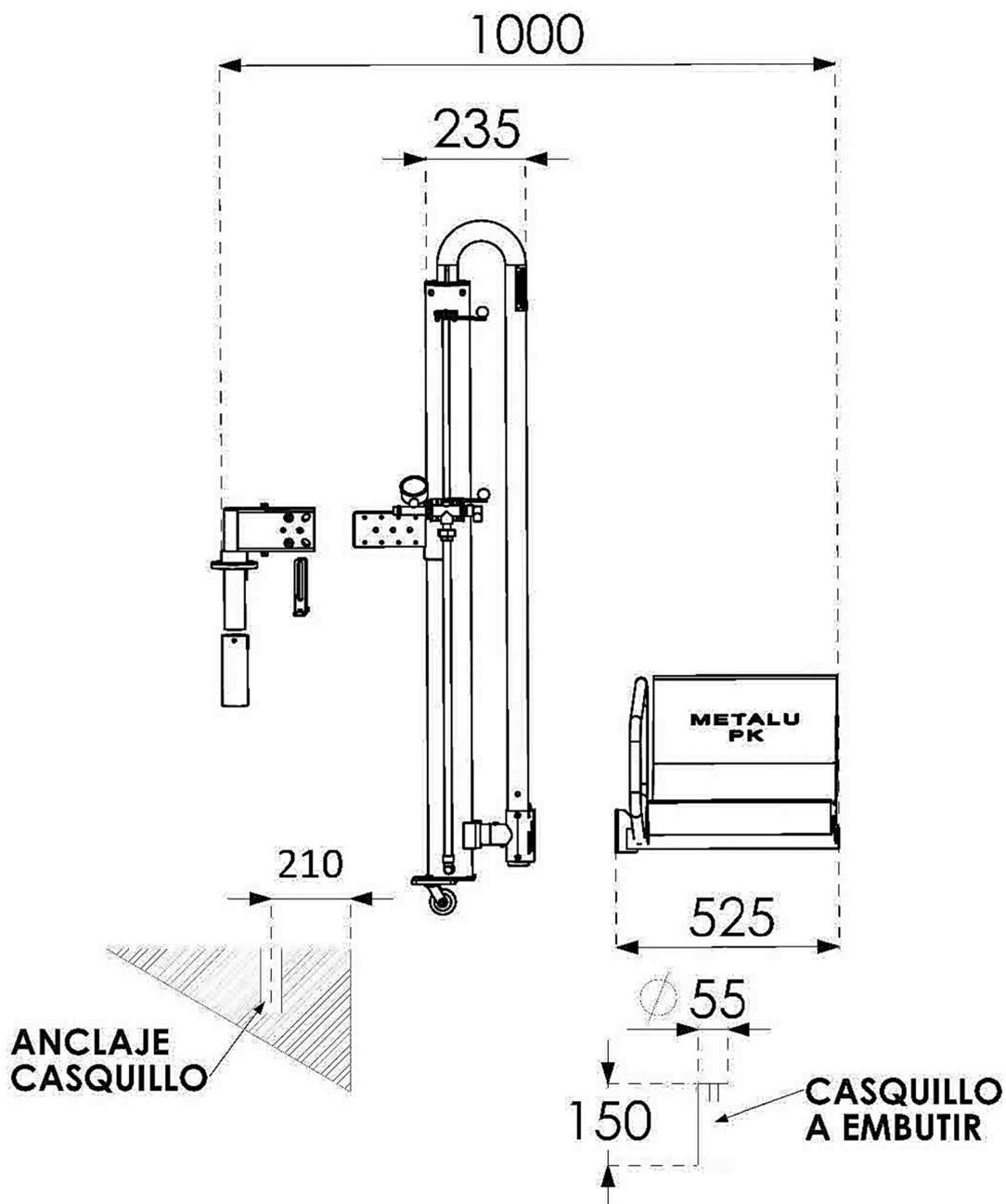
\*La distancia del anclaje (11) son medidas orientativas ya que esta no depende de la esquina de la piscina, 210 m/m, sino del punto de apoyo inferior (5) en la pared. Cualquier alteración (desnivel, resalte, escalón, etc.) cambiará la distancia del anclaje, por lo que este anclaje deberá efectuarse posicionando el elevador según se indica en las instrucciones de instalación.
