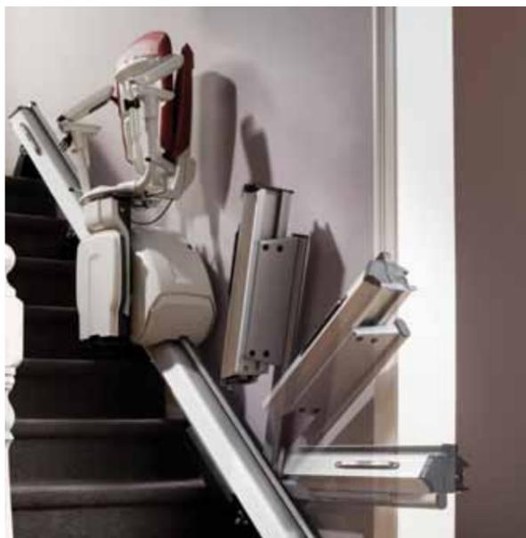
Si el pie de su escalera tiene una obstrucción puede elegir instalar un rail motorizado automático. Una vez utilizado el salvaescaleras, este vuelve a la parte superior de las escaleras y la sección más baja del raíl se pliega, dejando libre la parte inferior de las escaleras.
